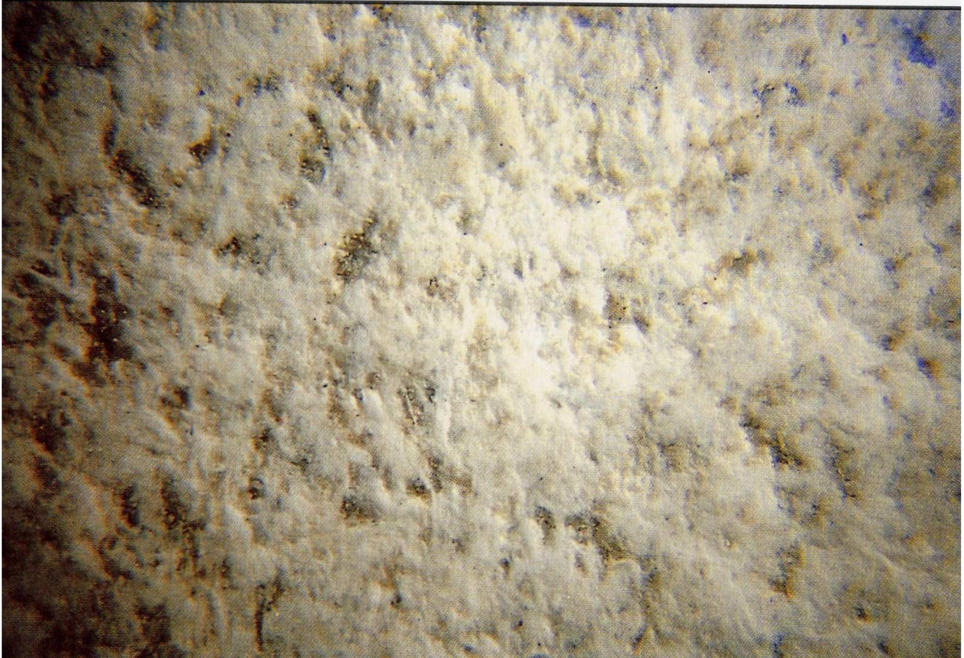
Fig 1.2 Superficie di lastra nuova (ingrandimento 160 x) (Chiappino e Venerandi, 1991)
